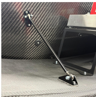
Tunnel brace rod
